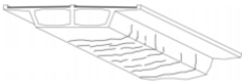
【그림 3.2.6】 프리스트레스트 거더별 조사부위 및 균열
